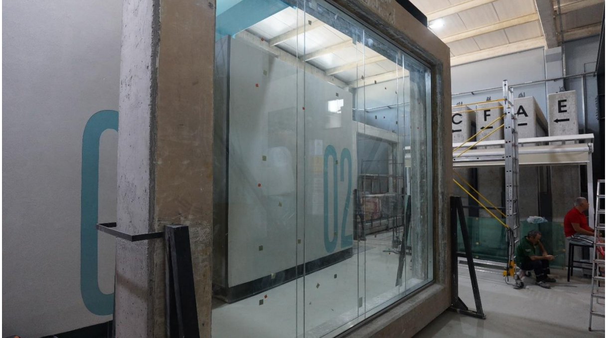
Şekil 3.8 Perspeka Sistem 10 mm Temperli Cam / 5 mm + 4 mm 1,52 A.PVB Lamine Cam Nihai Fotoğrafi
